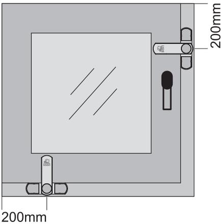
Abbildung 3: Montage des Befestigungsblocks
