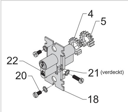
7. Setzen Sie den Profil-Doppelzylinder in die Zylinderplatte (18) ein und befestigen Sie den Zylinder mit der Schraube M5x15 (20) und Federscheibe (23).
